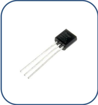
**Funcionalidade:** Medir a temperatura do ambiente que se encontra. Pode fazer medições de  $-55\text{ }^{\circ}\text{C}$  à  $150\text{ }^{\circ}\text{C}$ .
