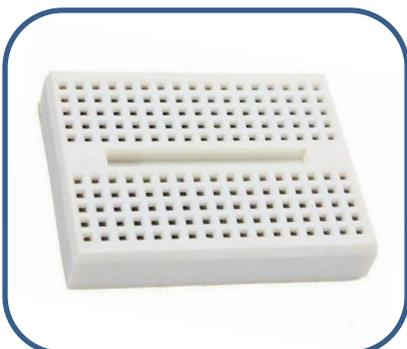
**Funcionalidade:** É uma placa plástica que permite a montagem de circuitos elétricos. Cada furo permite a conexão de um componente eletrônico.
